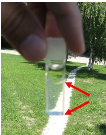
Silikagelový monolit (medzi šípkami) pripravený v kyvete
