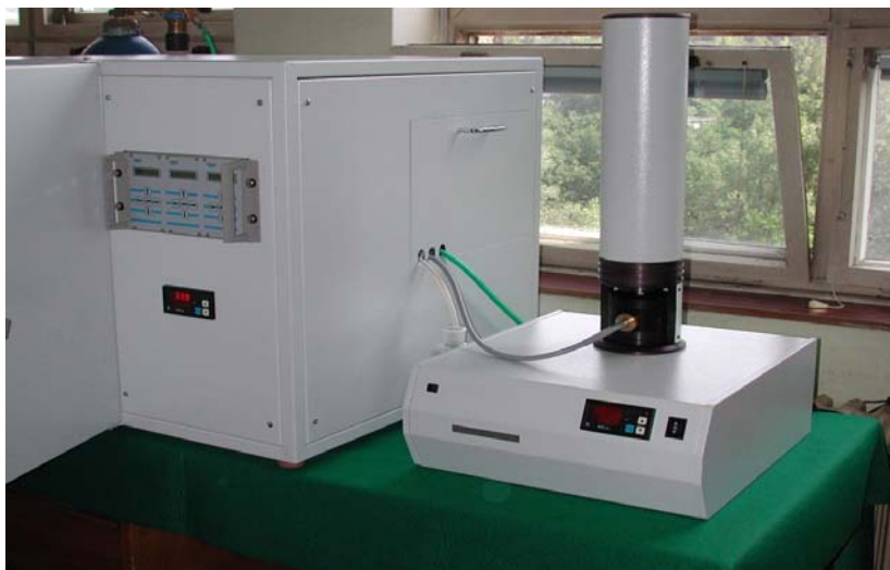
Interfejs pre nedeštruktívne meranie chemiluminiscencie Lumipol-3
